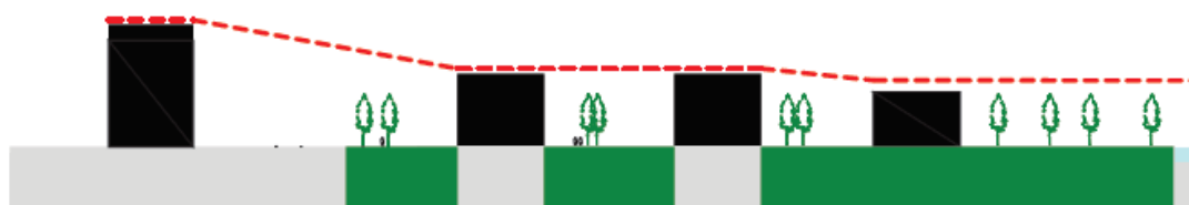
Afbeelding: doorsnede geluidswal en achterliggende twee-onder-een-kapwoningen [1]
